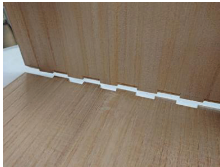
圖 17 缺損處之面板以隱鳩尾榫製作 （攝影／陳澄波）
