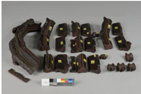
圖 5 雕紫檀甲子萬年十二方盒結構脫膠分離之狀況 (攝影/陳澄波)
