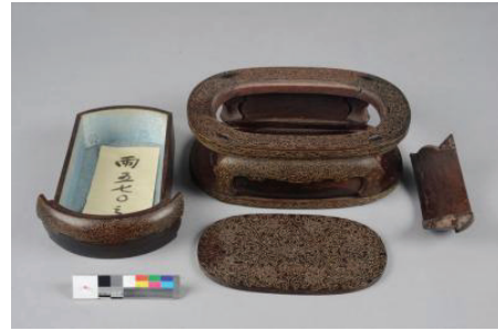
圖 2 青瓷水仙盆木座結構脫膠分離之狀況 （攝影／陳澄波）
