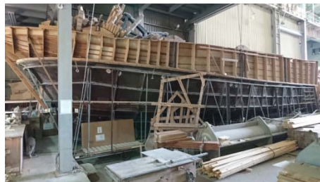
圖 4 高度修改的船模 (攝影／羅國棟)
