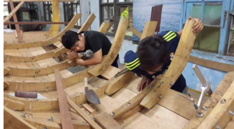
圖 2 縫隙吻合的觀察 (攝影／羅國棟)
